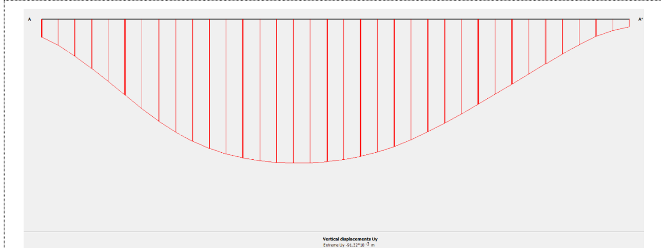
RM8-S1: Vertikalni pomaci na razini temeljnog tla na kontaktu nasipa i temeljnog tla
