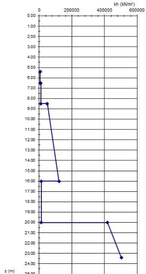
STUPIŠTE S6; potresno
