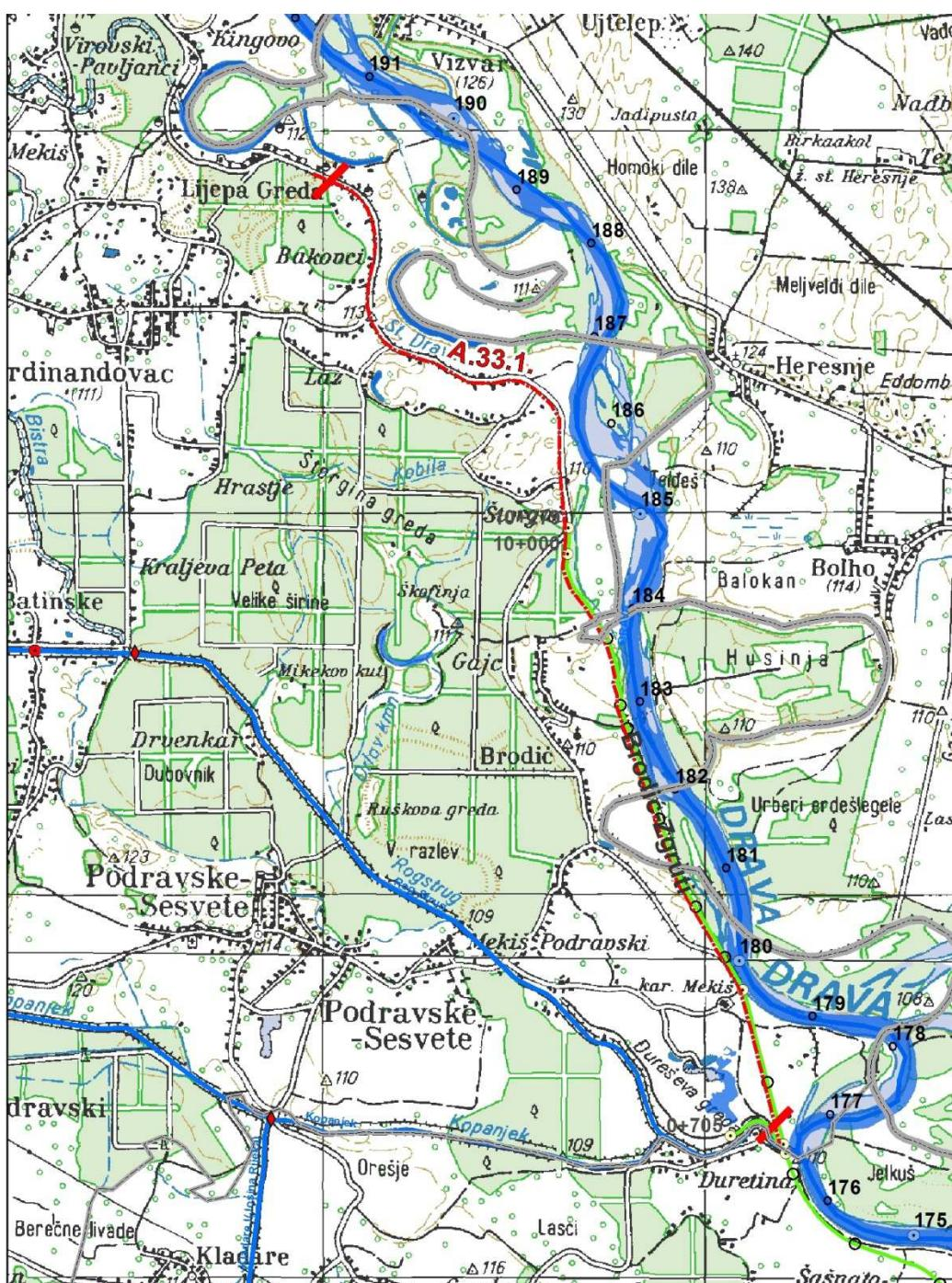
Dionica obuhvaća desnu obalu Drave od ušća kanala Rog-Strug do Lepa Grede u ukupnoj dužini od 12,4 km. Na desnoj obali Drave izведен je nasip Zgruti-Brodić u dužini od 6950 m, na koji se s nizvodne strane priključuje lijevi usporni nasip uz Rog-Strug. Na uzvodnoj strani nasip Zgruti-Brodić se priključuje na cestu Lepa Greda - Brodić.
