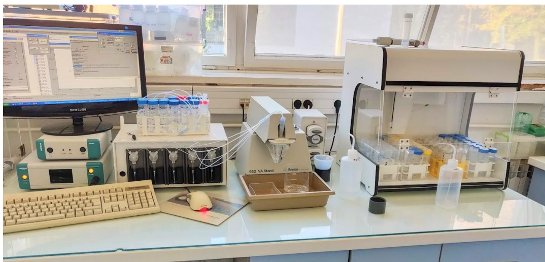
Slika 8.1.4. Automatizirani voltametrijski sustav za određivanje koncentracija Zn, Cd, Pb, Cu, Ni i Co.
