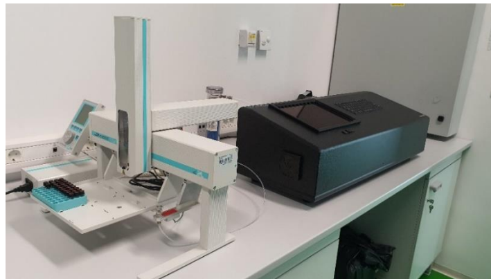
Slika 4.2.3. Apsorpcijski spektrometar za određivanje izotopnog sastava vode (Liquid Water Isotope analyzer, LWIA)
