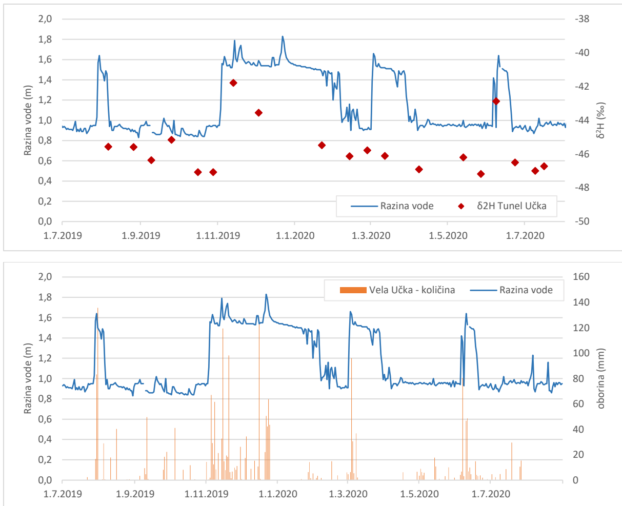
Slika 4.6.8. (gore) vremenska serija izotopa ^2\text{H} i razina vode u Tunelu Učka; (dolje) razina vode u Tunelu Učka i dnevna količina oborine na postaji Vela Učka (DHMZ).
