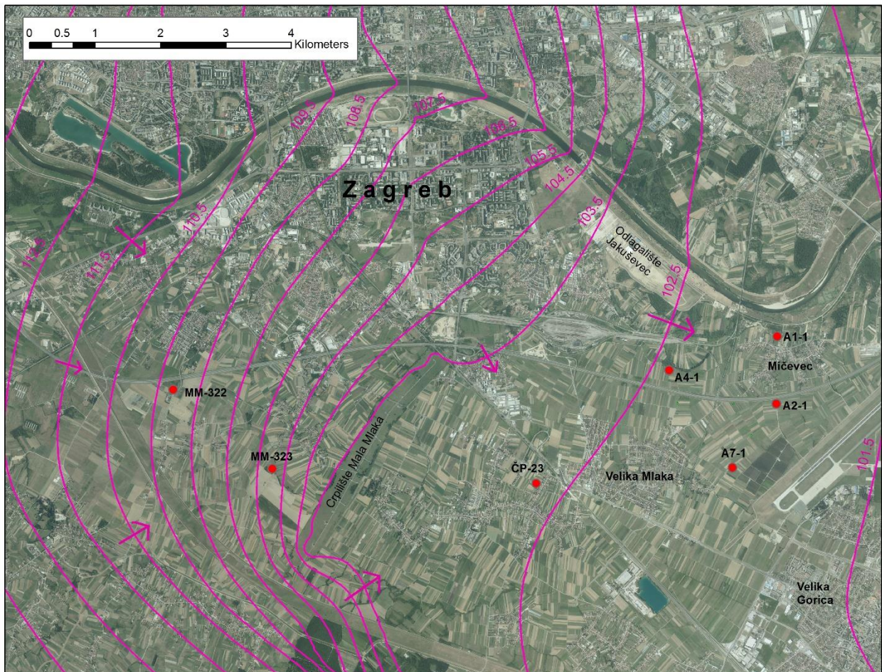
Slika 4.2. Hidroizohipse i smjer toka podzemne vode u uvjetima srednjih voda na istraživanom zagrebačkom području, te lokacije piezometara na kojima je istraživana starost podzemne vode
