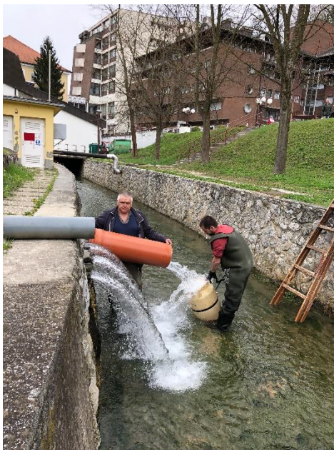
Slika 6.3.11. Mjerenje istjecanja termalne vode na izvorištu u Krapinskim Toplicama
