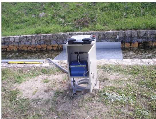
Slika 102: Mjerenje protoka u prelivnom kanalu (izvor: Studija aglomeracije Split-Solin)
