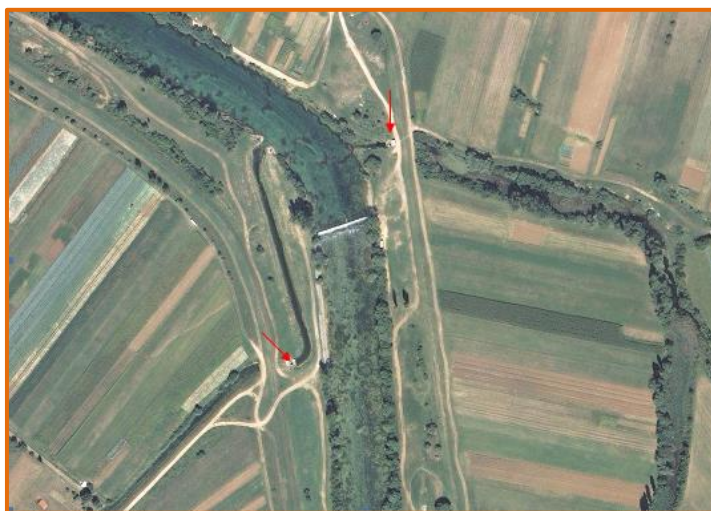
Slika 107: Vodozahvatne građevine za upuštanje voda Cetine za navodnjavanje lijevog i desnog zaobalja
