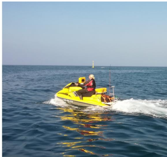
Slika 2.3: Korišteno plovilo SHORE jetski. Lijevo: kretanje jetski plovila s rampe. Desno: jetski tijekom mjerenja.
