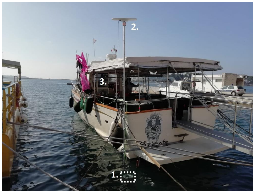
Slika 2.4: Stražnji dio plovila koristo se za mjerenje brzine morskih struja. Oznaka 1: ADCP spušten ispod razine vode. Oznaka 2: DGPS vertikalno poravnan s ADCP-om. Oznaka 3: mjesto računala u kabini čamca.
