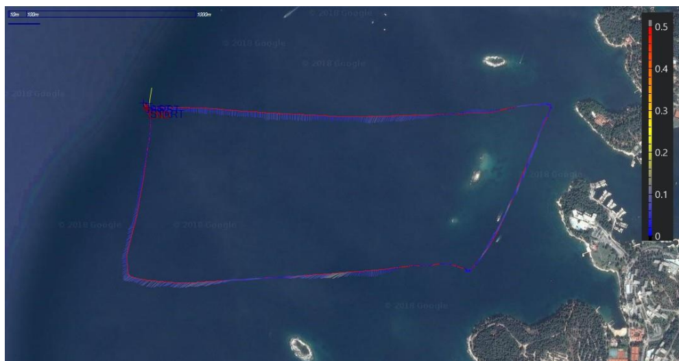
Slika 3.10: Uvjeti niske struje snimljeni između plime i oseke oko 14:00 UTC, u m/s
