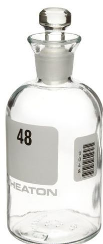
Slika 5.16 BOD boca za klasični BOD test (lijevo) i boce za kontinuirano mjerenje apsorpcije kisika (desno) (fotografije: Wheaton i Velp Scientifica).
