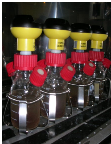
Slika 3.2 Komercijalno dostupna oprema za provedbu manometrijskih testova za potrebe denitrifikacije (fotografija: Lotti, 2016).
