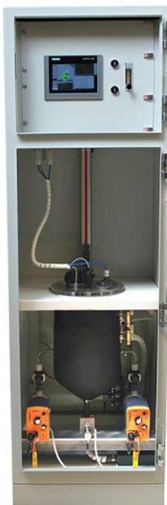
Slika 5.21 Primjer komercijalne verzije respirometra na principu LFS koja koristi strukturu prikazanu na slici 5.20. U sredini je termostatirana posuda, a na dnu, lijevo i desno, pumpe za dodavanje otpadne vode i kalibraciju (fotografija: Kelma NV).
