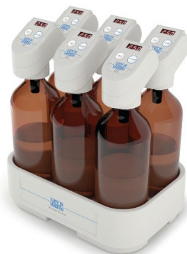
Slika 5.16 BOD boca za klasični BOD test (lijevo) i boce za kontinuirano mjerenje apsorpcije kisika (desno) (fotografije: Wheaton i Velp Scientifica).
