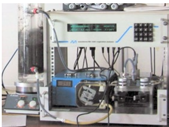
Slika 5.23 Primjer komercijalne verzije principa LSF koja koristi laboratorijsku opremu prikazanu na slici 5.22. Lijevo je laboratorijski aeracijski spremnik s aktivnim muljem. U kutiji s opremom lijevo je pumpa za uzorkovanje, a desno je skup solenoidnih ventila. Posuda je postavljena iza ventila (fotografija: Applitek NV).
