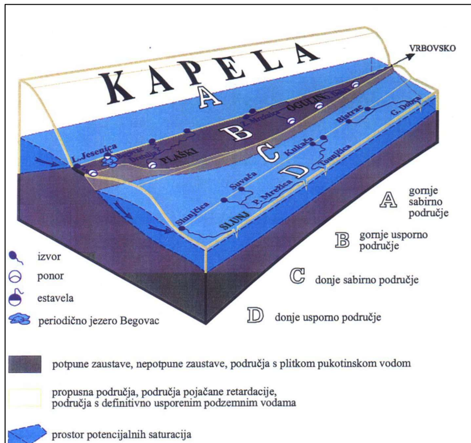
Slika 4-1. Shematizirani prikaz hidrogeoloških odnosa u prostoru Kapele, podkapelske Ogulinsko-plašćanskoj zaravni i Karlovačkom plitkom kršu (prema S. Bahun, 1967., modificirala A. Kovačević, 2005).
