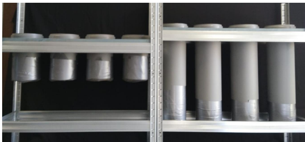
Slika 59. Kolone u neporušenom stanju u kontroliranim uvjetima laboratorija Zavoda za melioracije - MELILAB
