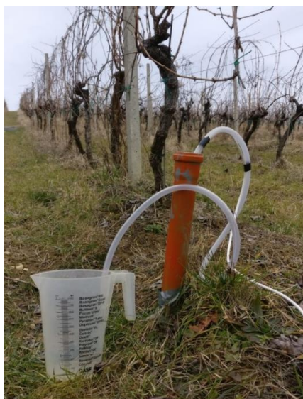
Slika 4. Uzorkovanje perkolata lizimetra na lokaciji Jazbina
