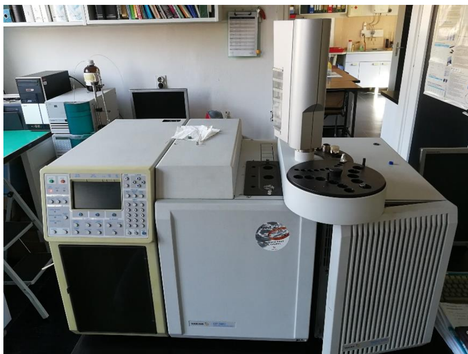
Slika 67. Vezani sustav plinski kromatograf-spektrometar masa (GC-MS, Varian)
