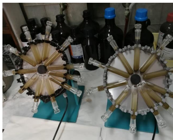
Slika 64. Vodene suspenzije tla u sorpcijskom pokusu (rotacijsko miješanje)
