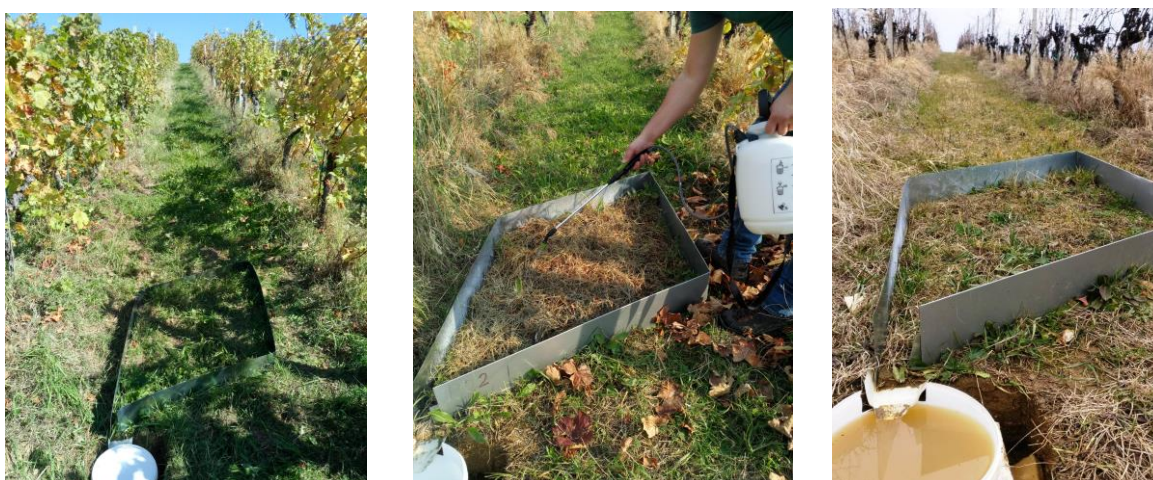
Slika 5. Sakupljač površinskog otjecanja neposredno nakon postavljanja (lijevo), simulacija kišenja unutar sakupljača (sredina), prikaz sakupljača i spremnika neposredno pred uzorkovanje (desno)
