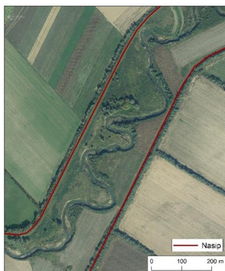
Slika 3.7: Primjer slobodnog bočnog kretanja vodotoka unutar nasipa u širini pojasa meandara – isječak ortofoto snimke toka rijeke Orljave (vodno tijelo CSRN0015_002)
