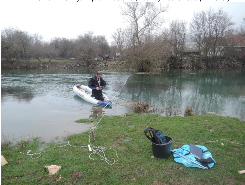
Slika 4.2.4. Mjerenje visokih voda iz čamca na profilu Tonković-Klanac (11.2019.)
