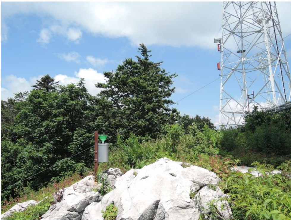
Slika 4.1.12. Sakupljač kumulativne oborine na vrhu Stipanov Grič
