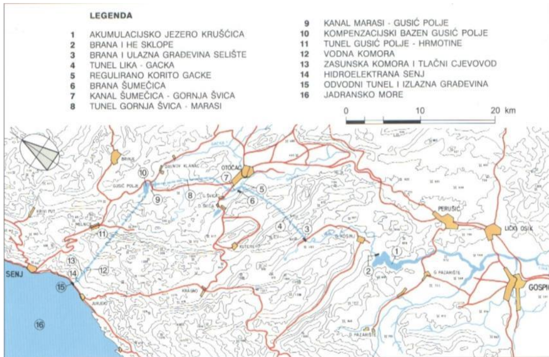
Slika 2.4.2. Pregledna situacija hidroenergetskog sustava Senj (Elektroprojekt, 2000a)
