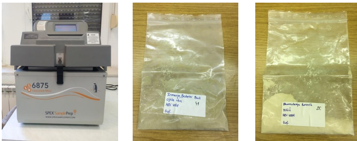
Slika 3.1.1.4. Postupak kriogenog mljevenja: a) na kriogenom mlinu (6875 Freezer/Mill, Spex, SAD); b) uzorak cijele ribe nakon kriogenog mljevenja; c) uzorak mišića ribe nakon kriogenog mljevenja
