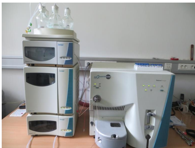
Slika 4.1.4.1. LC-MS/MS instrument za određivanje PFOS, HBCD i kvinoksifena.
