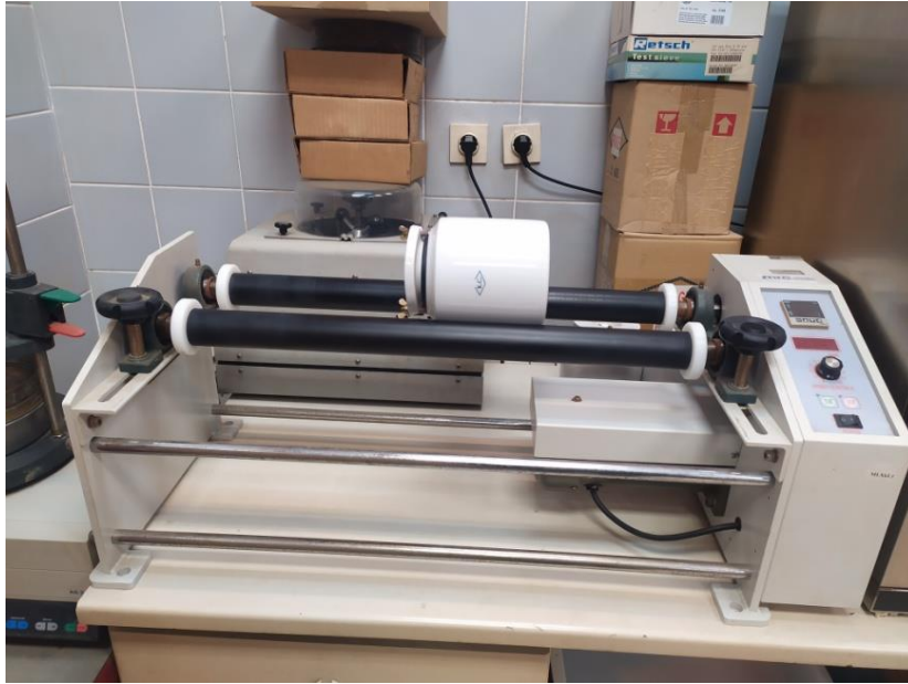
Slika 3.2.2. Kuglični mlin koji je upotrebljen za mljevenje i homogenizaciju uzoraka sedimenta (frakcija <math>< 2\text{ mm}</math>).
