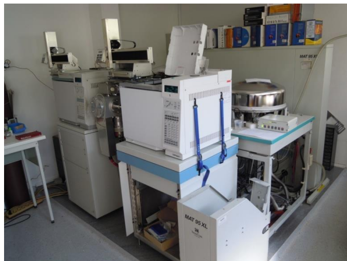
Slika 4.1.8.1. Instrument (HRMS-Finnigan MAT 95 XL-upgraded to MAT XP) za određivanje dioksina (NZLOH)
