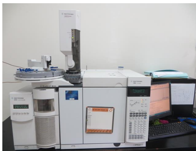
Slika 4.1.1.1. GC-MS instrument za određivanje PAH-ova, pesticida i polibromiranih difeniletera.
