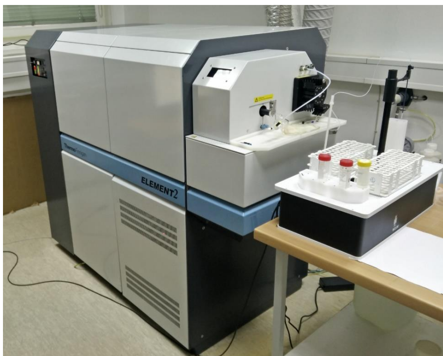
Slika 4.2.1.1. Instrument HR ICPMS za određivanje onečišćujućih toksičnih metala te aluminija (Al) i fosfora (P) u sedimentu.
