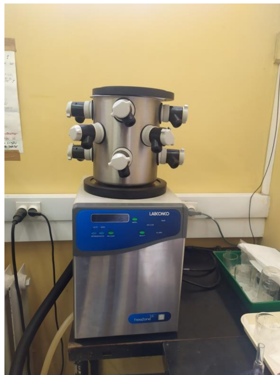
Slika 3.2.3. Liofilizator (Freezone 2,5; Labconco) koji je upotrebljen liofilizaciju uzoraka fine frakcije sedimenta.
