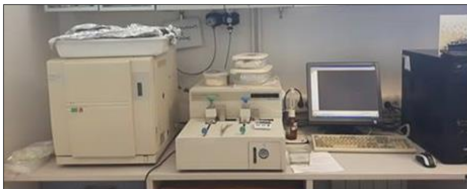
Slika 4.3.5.1. TOC- V_{CPH} (analizator organskog ugljika) + SSM-5000A (modul za krute uzorke), Shimadzu
