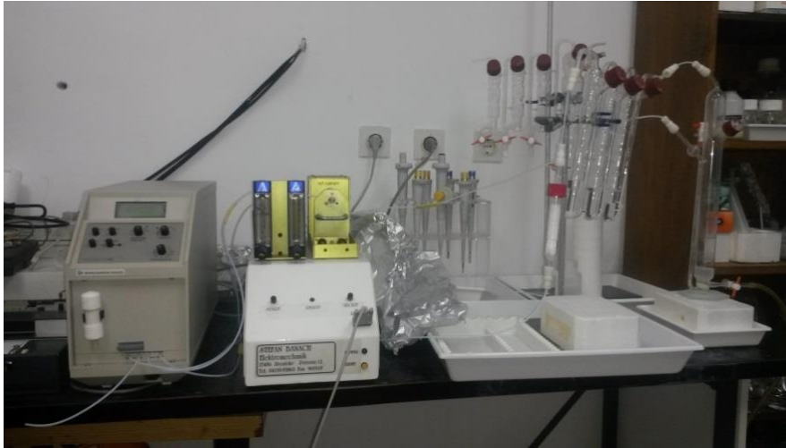
Slika 4.1.7.1. Uređaj za analizu žive - CV-AAS, Mercury Monitor 3200, (Thermo Separation Products, SAD)
