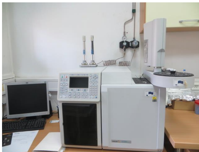
Slika 4.2.3.1. Instrument GC-PFPD za određivanje TBT-a u sedimentu.
