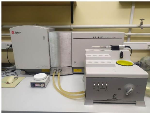
Slika 4.3.2.1. Instrument laserski difraktometar za određivanje veličine čestica sedimenta.
