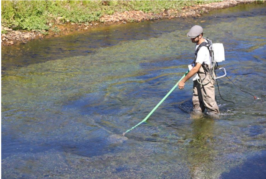
Slika 2.2.1.1. Izlov riba hodanjem po rijeci elektroribolovnim agregatom Hans-Grassl IG200-1B izlazne snage 5 kW.
