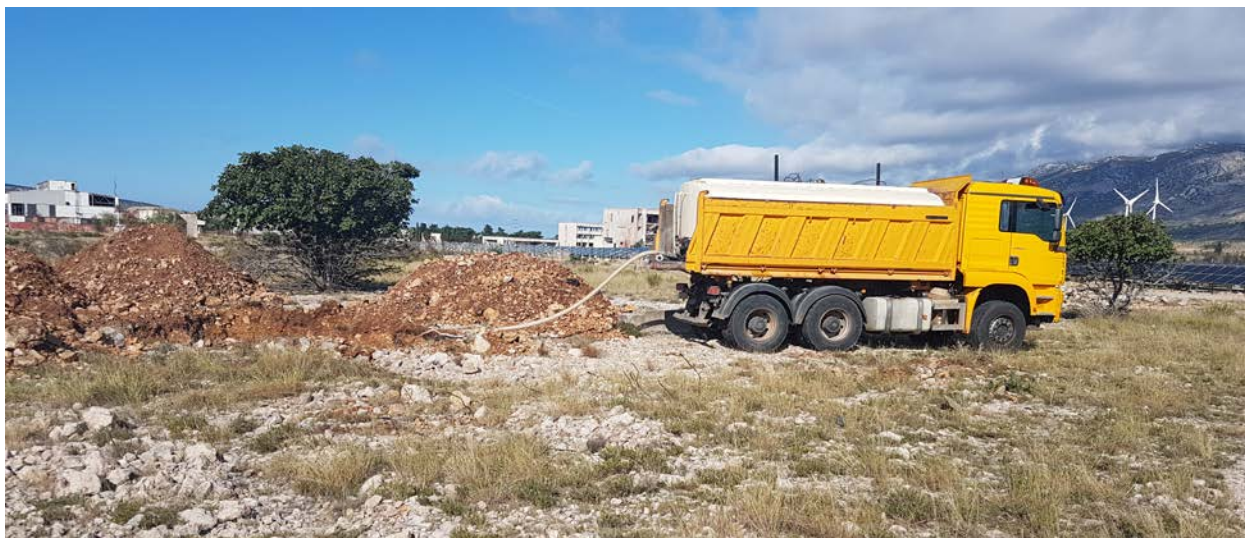
Fot. 4: Testiranje upojnosti izvedeno je nalijevanjem 12 m 3 čiste vode dopremljene cisternom.
