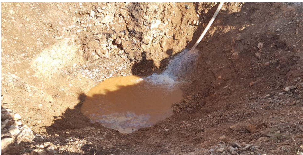
Fot. 5: Sva voda otekla je u podzemlje kroz 15 minuta, dakle prosječnim kapacitetom upoja od 13,3 L/s
