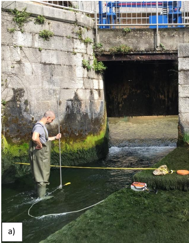
Slika 3.6. Pozicija mjerenja protoka a) u odvodnom kanalu glavne zapornice dne 4.5.2018. i b) u koritu Rječine dne 29.5.2018.
