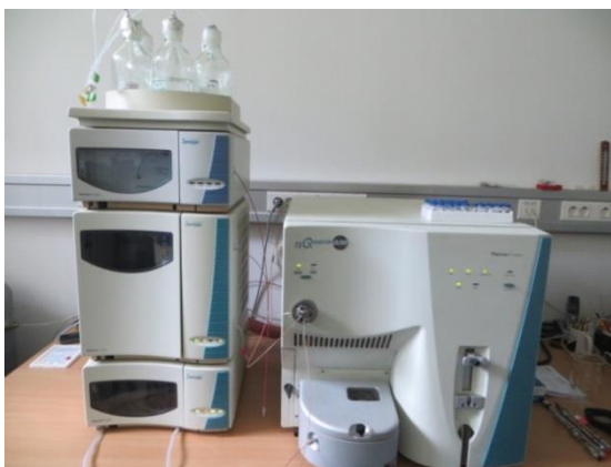
Slika 1.5.5.1. Vezani sustav tekućinska kromatografija tandemna spektrometrija masa (LC-MS/MS) za određivanje herbicida, PFOS i HBCDD.
