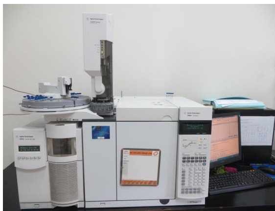
Slika 1.5.2.1. Vezani sustav plinska kromatografija-spektrometrija masa (GC-MS) za određivanje pesticida i PAH-ova.
