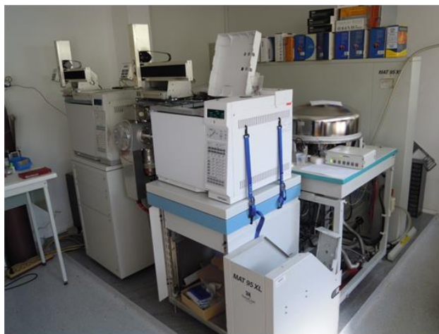
Slika 1.5.8.1. Vezani sustav plinske kromatografije visoke razlučivosti i spektrometrije masa visoke razlučivosti (HRGC/HRMS-Finnigan MAT 95 XL-upgraded to MAT XP) za određivanje dioksina u bioti
