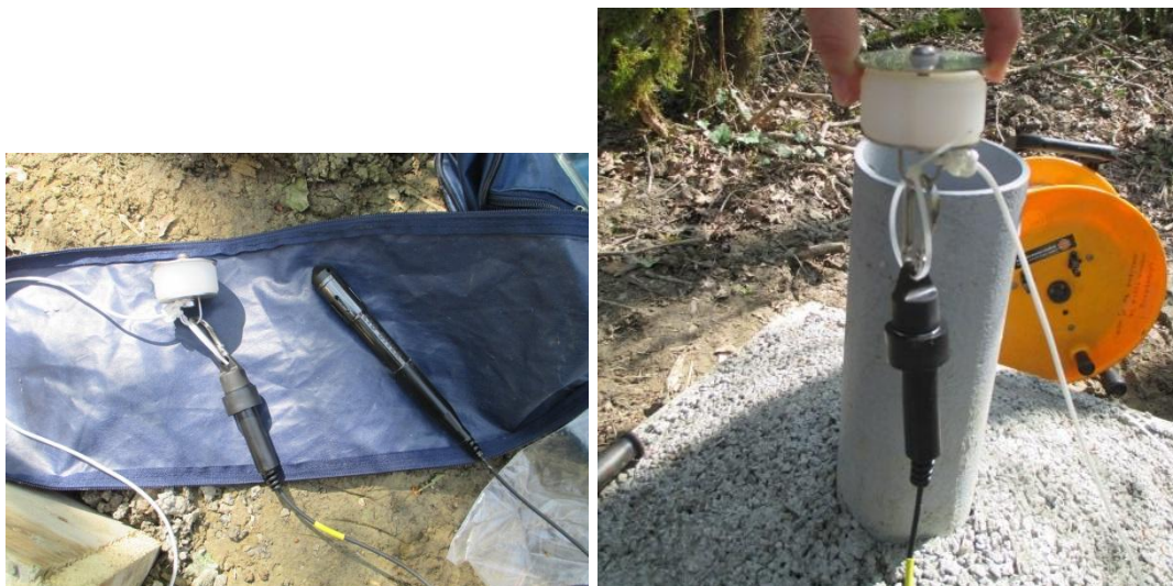
Slika 69. CTD Diver prije postavljanja u piezometar
