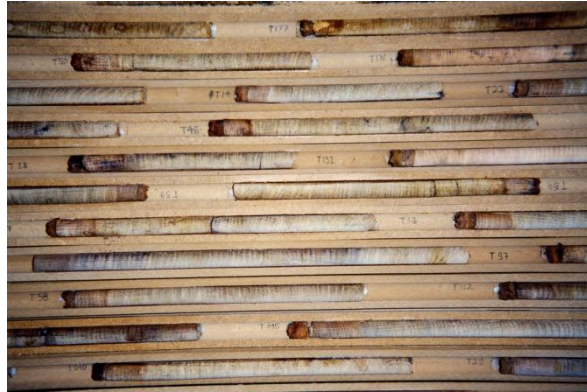
Slika 166 Izbrušeni i fiksirani izvrtci unutar nosača
