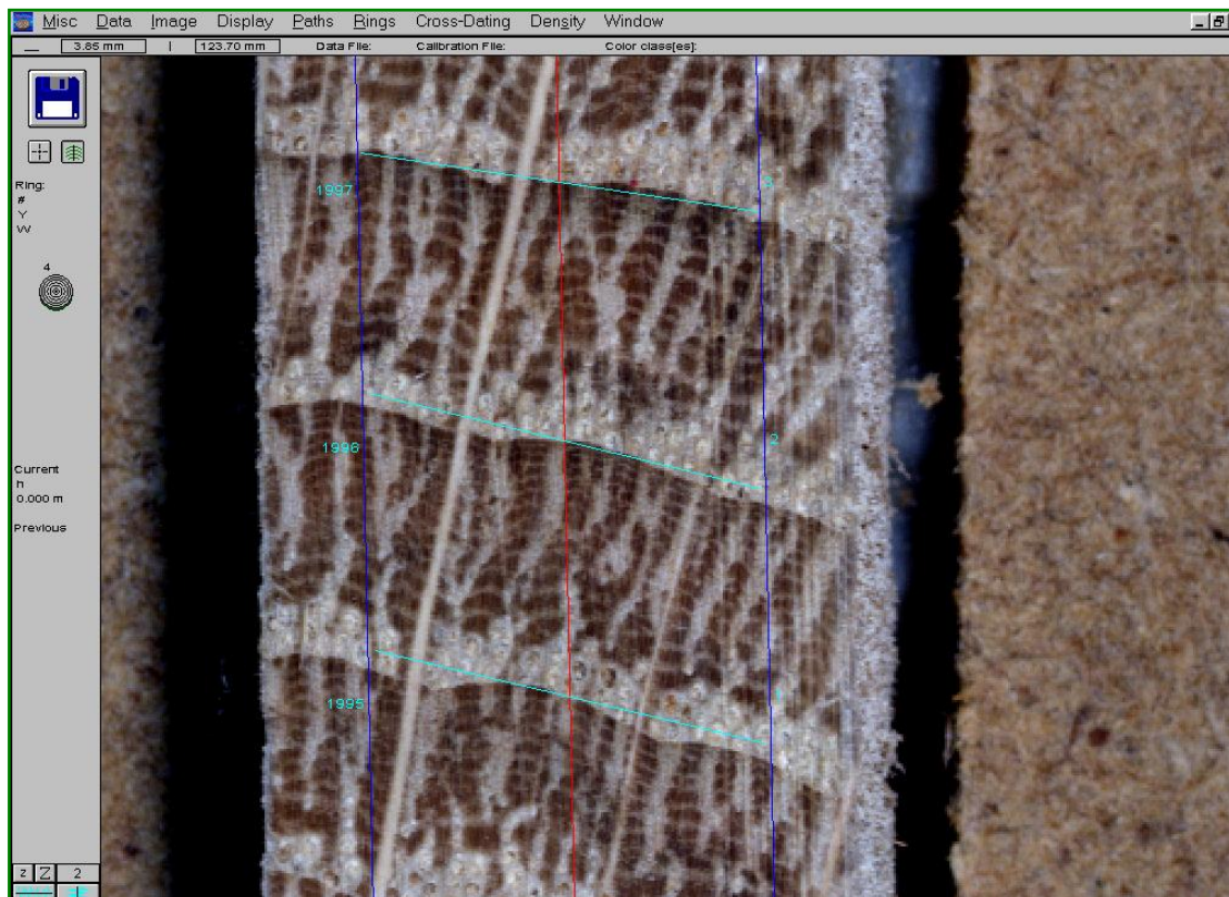
Slika 167. Digitalna izmjera širine i nagiba godova vršena ručnim namještanjem markica-linija na granicu goda te namještanjem kuta tangente na god u smjeru mjerne putanje prikazana u povećanju korištenom za izmjeru.
