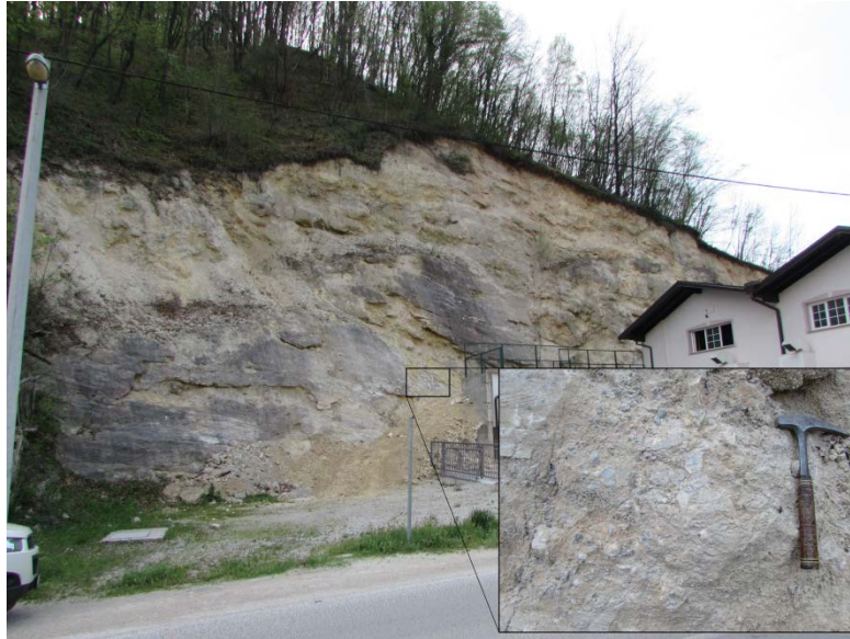
Slika 4.11. Rasjed s horizontalnim pomakom i tektonska breča na površini rasjedne plohe u selu Grdanjci.
