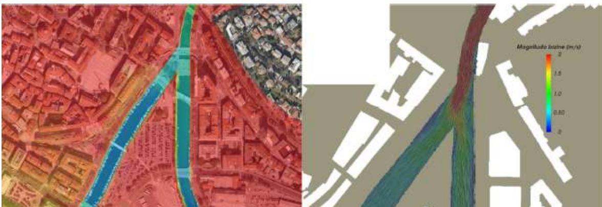
Slika 6.8. Spojno rješenje korita Rječine i Mrtvog kanala tip 4 (lijevo) i prikaz strujnica i magnituda brzine strujanja (desno, Q=100 \text{ m}^3/\text{s} i H_m=0,0 \text{ m n.m.} ), (Tehnički fakultet Rijeka, 2015)
