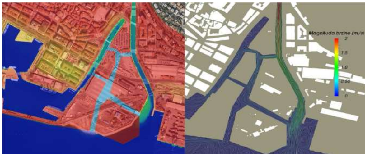
Slika 6.9. Varijantno rješenje kanalnog sustava prema urbanističkom rješenju uređenja područja Delte (lijevo) i prikazom strujnica i magnituda brzine strujanja (desno, Q=100 \text{ m}^3/\text{s} i H_m=0,0 \text{ m n.m.} ), (Tehnički fakultet Rijeka, 2015)
