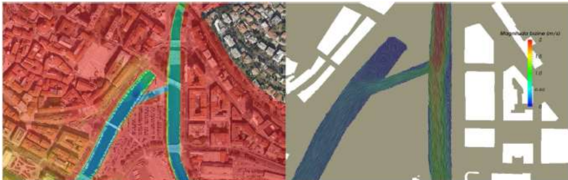
Slika 6.4. Spojno rješenje korita Rječine i Mrtvog kanala tip 1B sa varijantom širine kanala 15 m (lijevo) i prikazom strujnica i magnituda brzine strujanja (desno, Q=100 \text{ m}^3/\text{s} i H_m=0,0 \text{ m n.m.} ), (Tehnički fakultet Rijeka, 2015).
