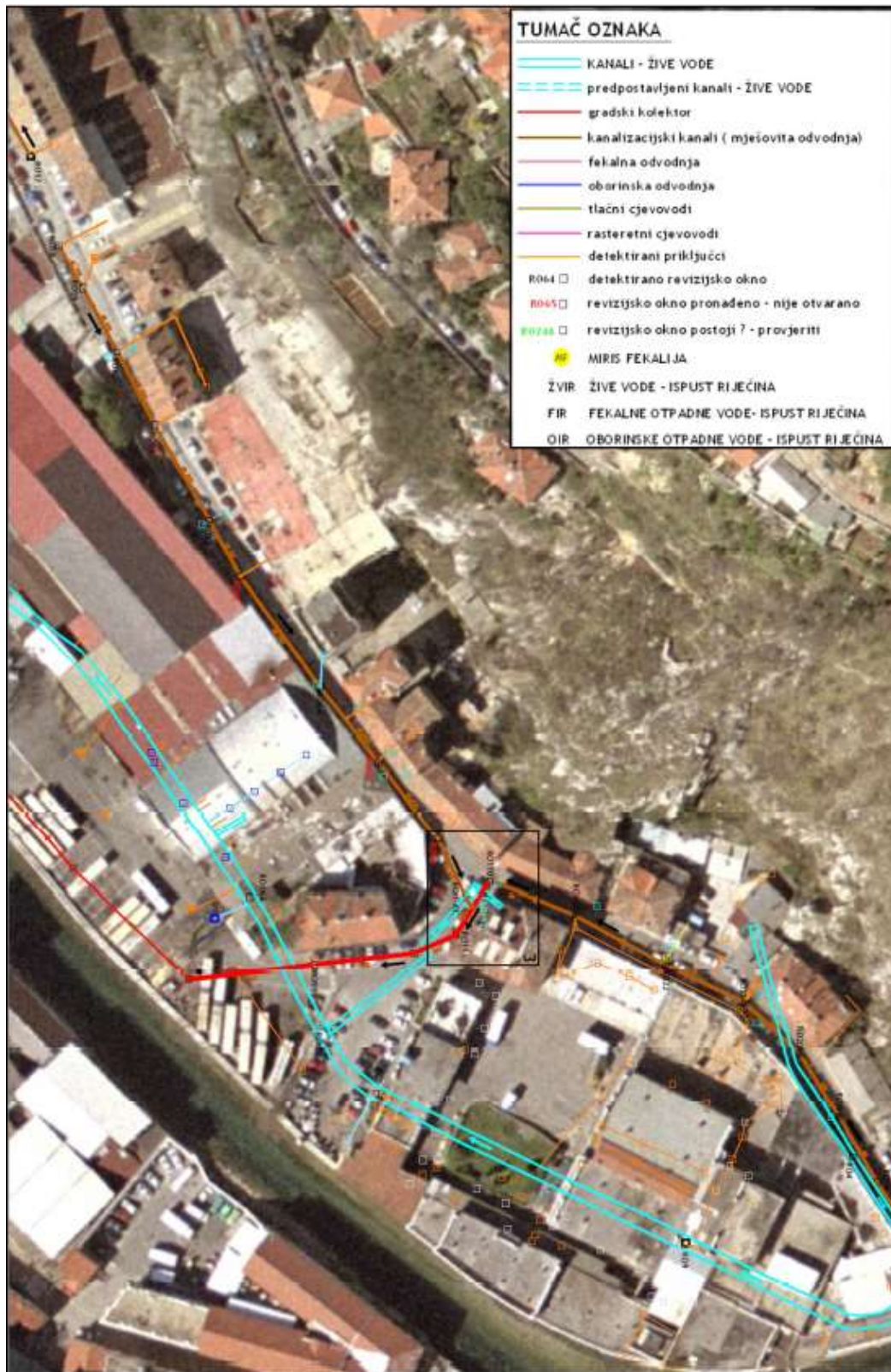
Slika 2.25. Detektirani kolektori kanalizacijskog sustava na početnom dijelu Vodovodne ulice, područje tvrtke Autotrolej (Institut IGH d.d. Zagreb, 2011).
