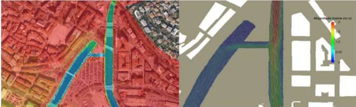
Slika 6.6. Spojno rješenje korita Rječine i Mrtvog kanala tip 2B sa varijantom širine kanala 15 m (lijevo) i prikazom strujnica i magnituda brzine strujanja (desno, Q=100 \text{ m}^3/\text{s} i H_m=0,0 \text{ m n.m.} ), (Tehnički fakultet Rijeka, 2015)
