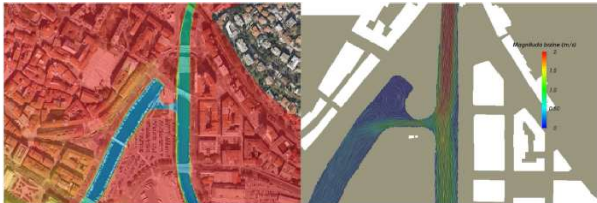
Slika 6.7. Spojno rješenje korita Rječine i Mrtvog kanala tip 3 (lijevo) i prikaz strujnica i magnituda brzine strujanja (desno, Q=100 \text{ m}^3/\text{s} i H_m=0,0 \text{ m n.m.} ), (Tehnički fakultet Rijeka, 2015)
