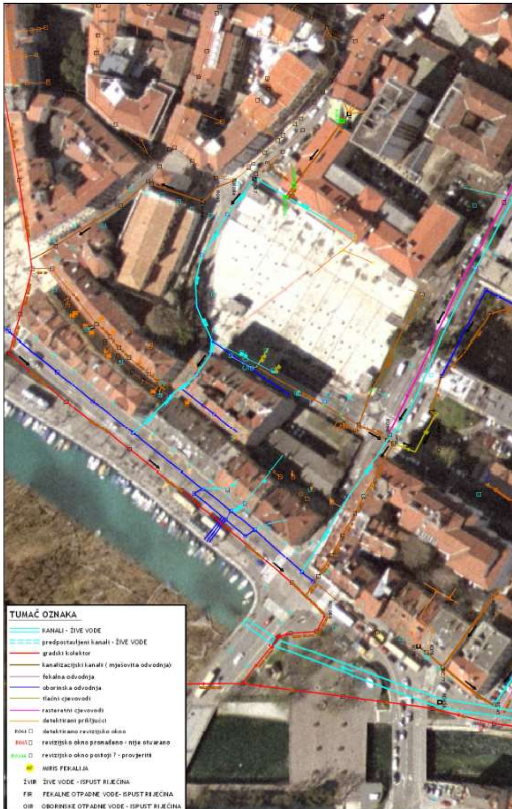
Slika 2.27. Detektirani kolektori kanalizacijskog sustava u neposrednoj blizini Mrtvog kanala (Institut IGH d.d. Zagreb,2011).
