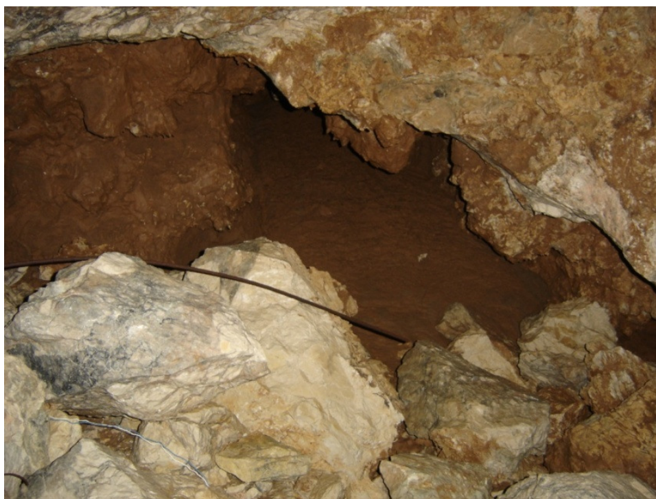
Slika 14. Kaverna od više desetaka metara u trijaskim dolomitima, snimljeno u potkopima cca 400 m ispod površine terena (istraživački potkopi za HE Ombla)
