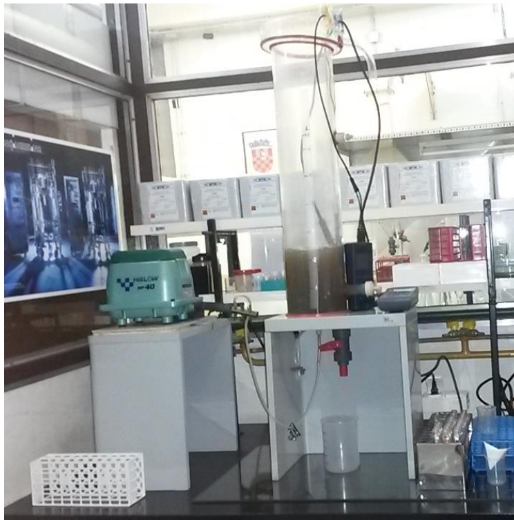
Slika 4. Bioreaktor korišten za pokuse nitrifikacije i denitrifikacije
