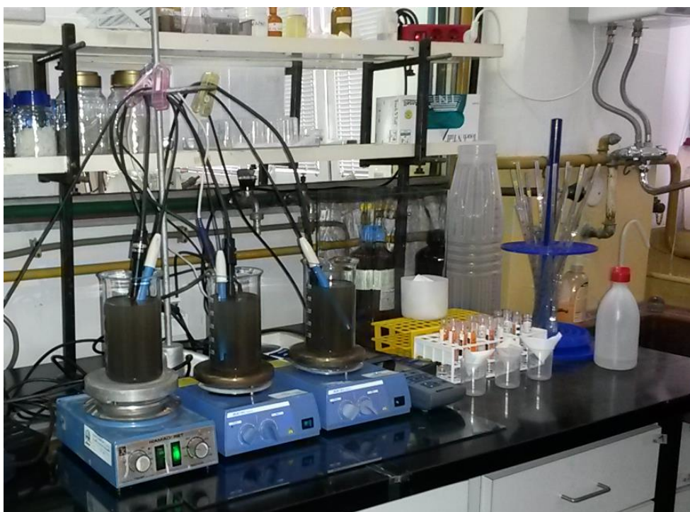
Slika 5. Aparatura za pokuse denitrifikacije
