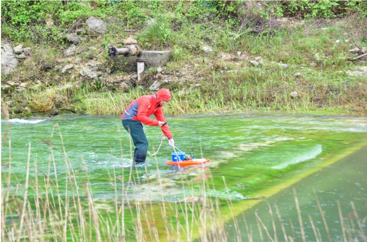
Slika 74. Mjerni profili prije ulaza u tunel Baćinska jezera – more (točka T3).
