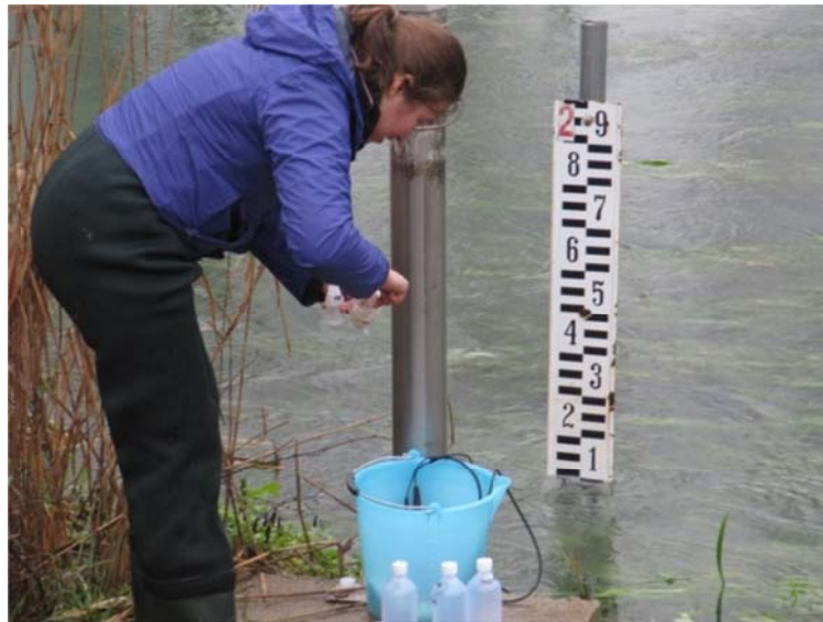
Slika 78. Prikupljanje uzoraka u bočice različitih volumena
