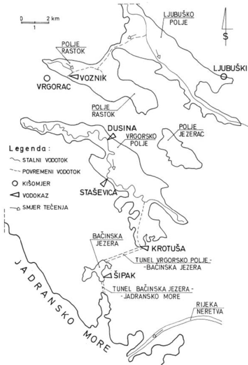
Slika 111. Shematizirani situacijski prikaz hidrotehničkih rješenja povezanosti Baćinskih jezera s poljima u njegovom zaleđu - preuzeto iz BONACCI, 2005)
