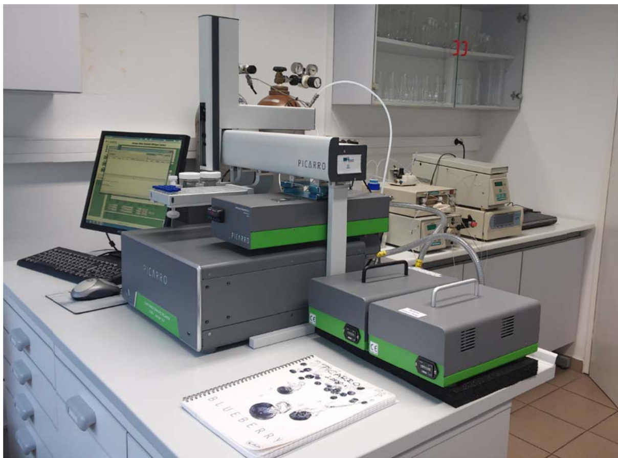
Slika 80. Picarro L-2130i izotopni analizator kupljen u sklopu međunarodnog IPA Adriatic projekta DRINKADRIA (financiran od strane EU) i korišten pri hidrogeološkom istraživanju Baćinskih jezera.
