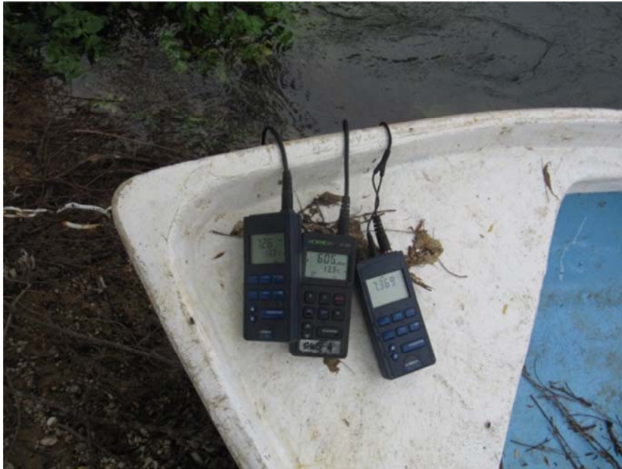
Slika 75. In situ mjerenje fizikalno-kemijskih pokazatelja ručnim sondama tvrtke WTW.
