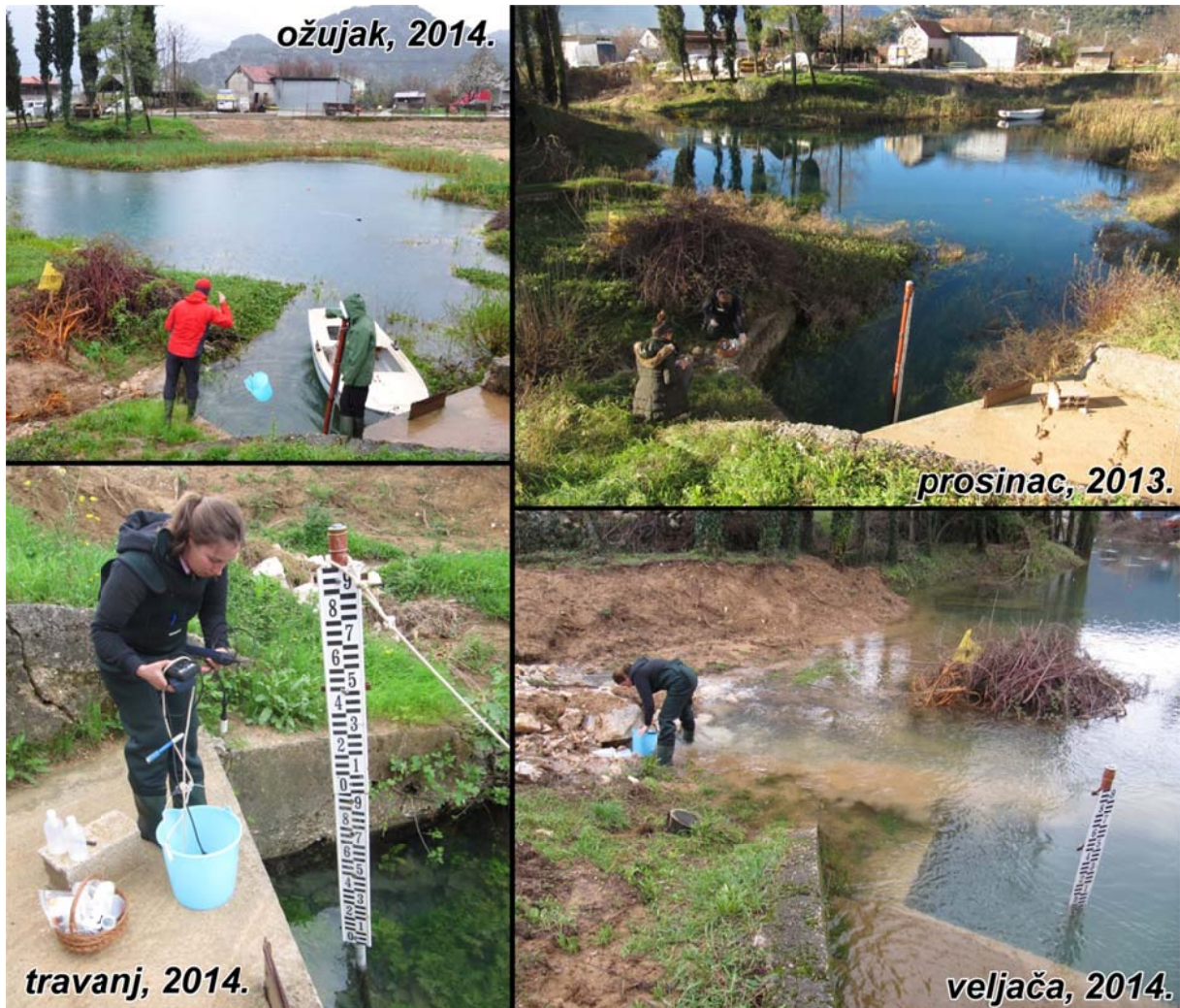
Slika 50. Cijev s mjernom letvom i logerom postavljena na izvoru Butina.
