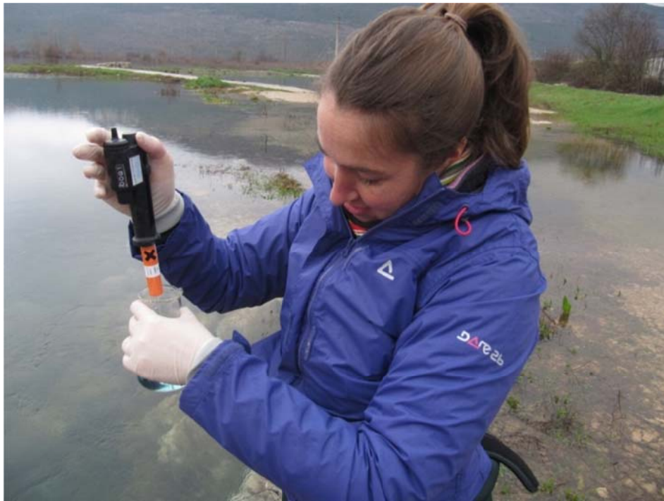
Slika 76. Analiziranje uzorka metodom titracije.
