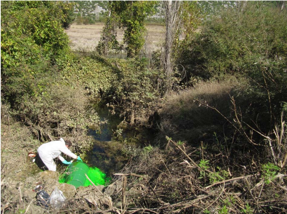
Slika 7. Ubacivanje Na-fluoresceina u ponor u sjeverozapadnom dijelu Vrgoračkog polja.
