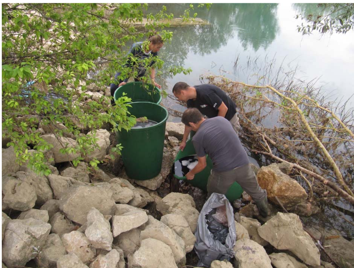
Slika 9. Ubacivanje naftionata među kamene blokove kod ponora Crpala.
