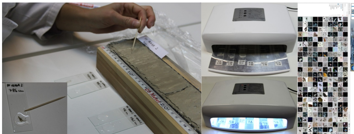
Slika 24. Izrada „smear slide“ preparata za mikroskopsku analizu nekonsolidiranih uzoraka, pomoću UV lampe i interpretacija podataka uz pomoć TMI baze.
