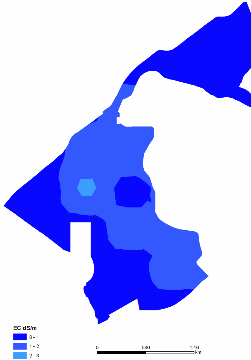
Karta zaslanjenosti tla na dubini 0-25 cm dobivena interpolacijskom metodom inverzne udaljenosti (IDW)
