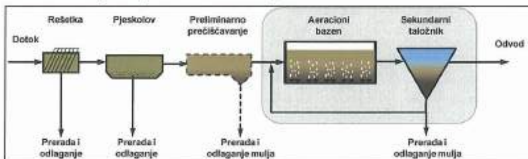
Slika 5.37: Shematski prikaz konvencionalnog postupka s aktivnim muljem.
