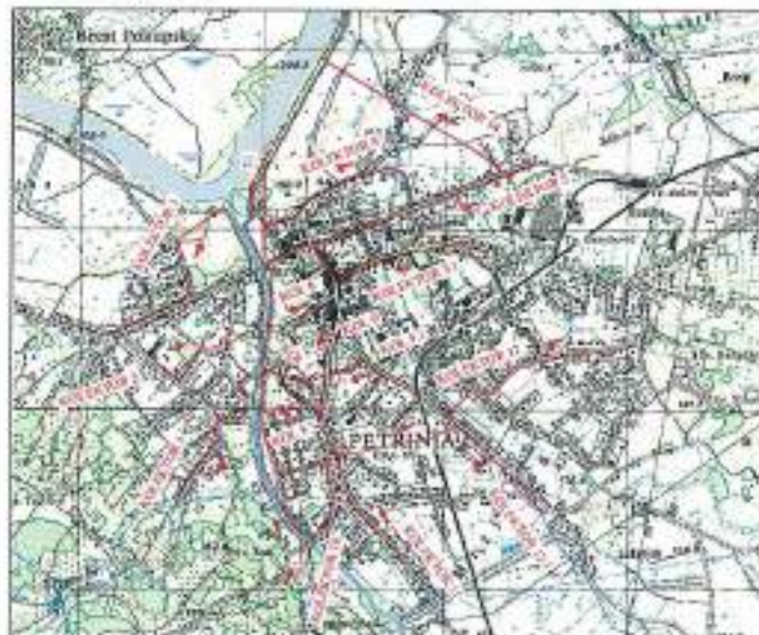
Slika 5.16: Postojeće stanje odvodnje otpadnih voda grada Petrinje.
