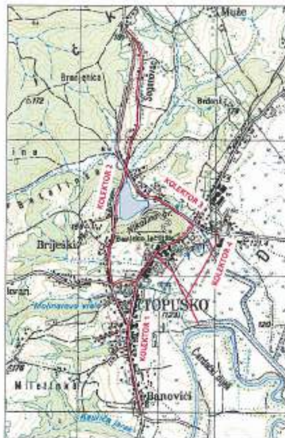
Slika 5.28: Postojeći sustav odvodnje naselja Topusko.
