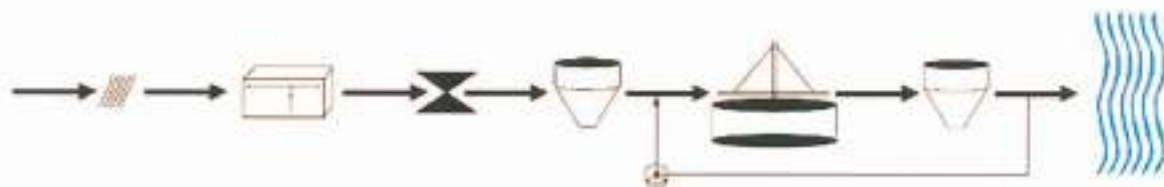
Slika 1.5.4.8. Shema uređaja s prokapsnikom
