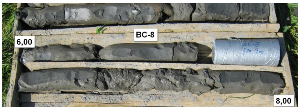
Slika 2. Jezgra istražne bušotine BC-8 (6,0-8,0 m)
