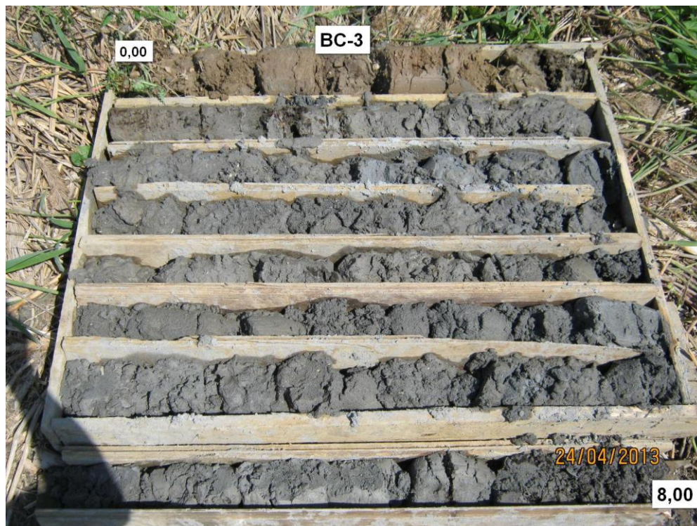
Slika 1. Jezgra istražne bušotine BC-3 (0,0-8,0 m)
