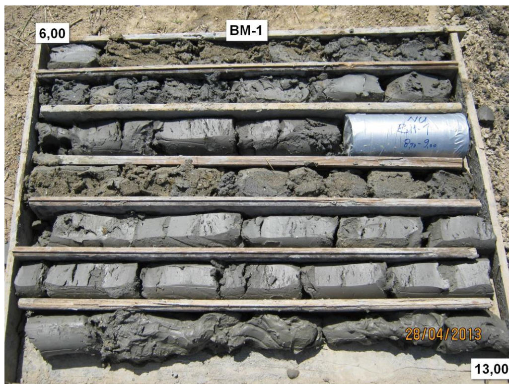
Slika 2. Jezgra istražne bušotine BM-1 (6,0-13,0 m)
