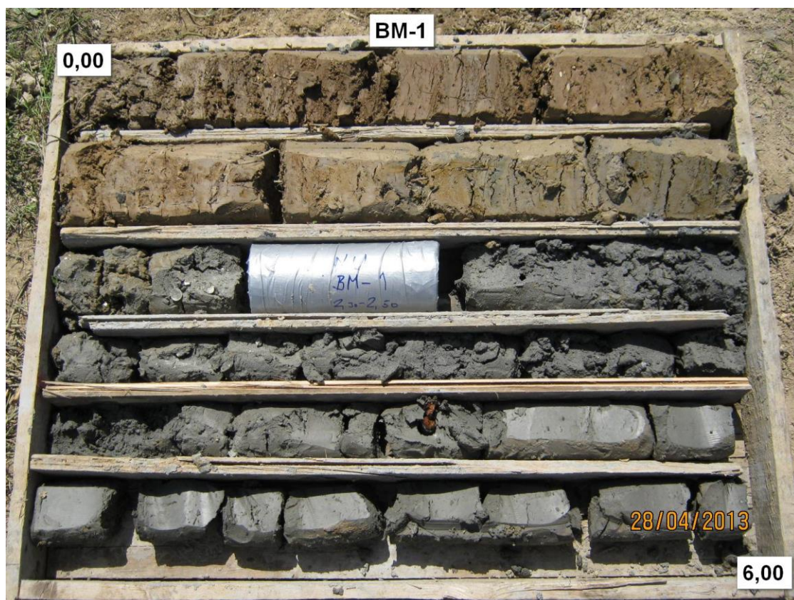
Slika 1. Jezgra istražne bušotine BM-1 (0,0-6,0 m)
