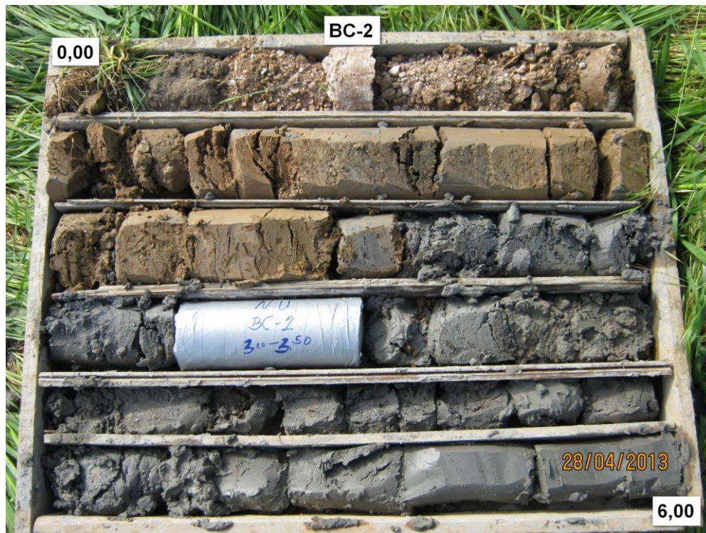
Slika 1. Jezgra istražne bušotine BC-2 (0,0-6,0 m)
