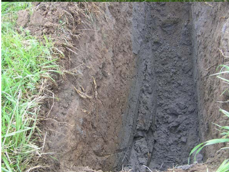
FOTOGRAFIJA 2. PRESJEK ISTRAŽNE JAME IJ-1
