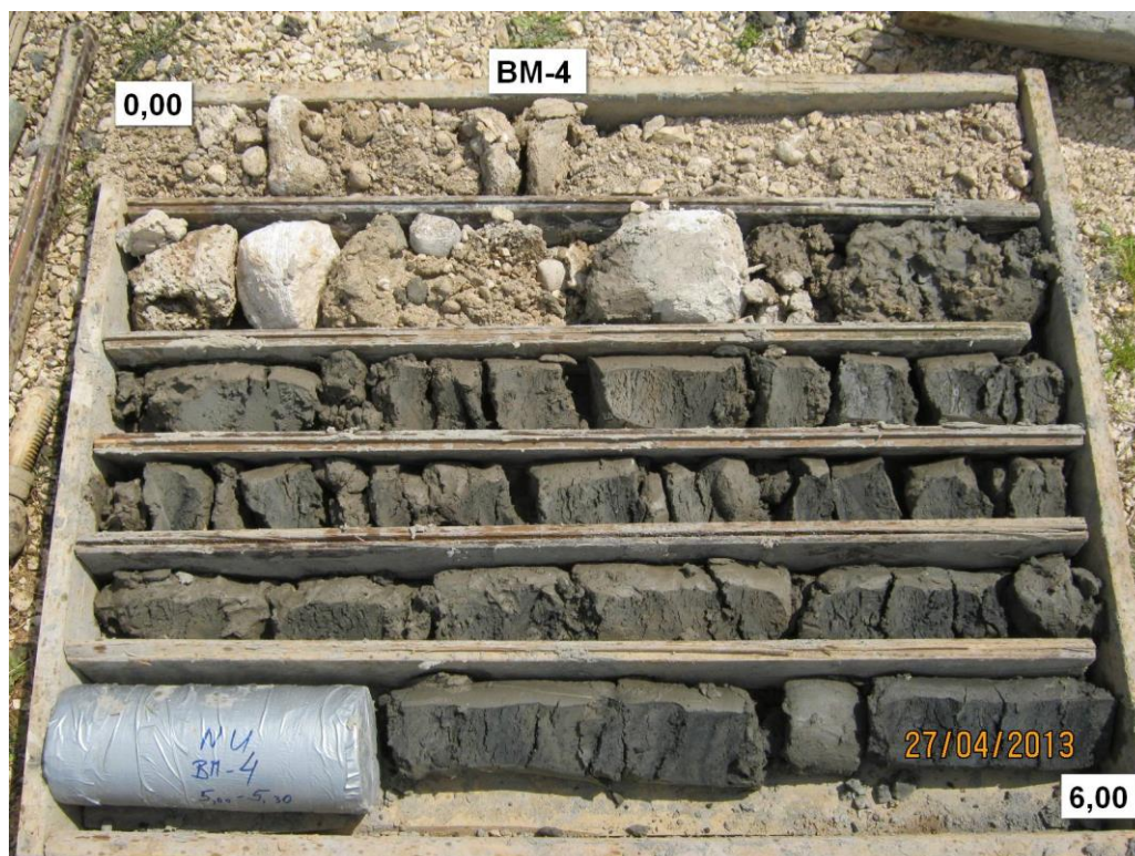
Slika 1. Jezgra istražne bušotine BM-4 (0,0-6,0 m)
