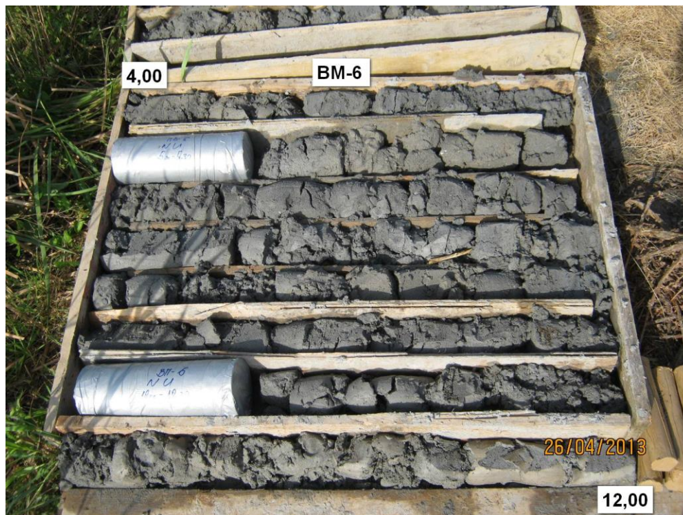
Slika 2. Jezgra istražne bušotine BM-6 (4,0-12,0 m)
