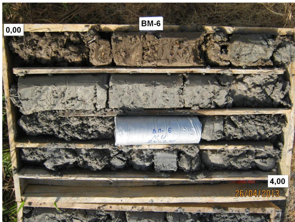
Slika 1. Jezgra istražne bušotine BM-6 (0,0-4,0 m)
