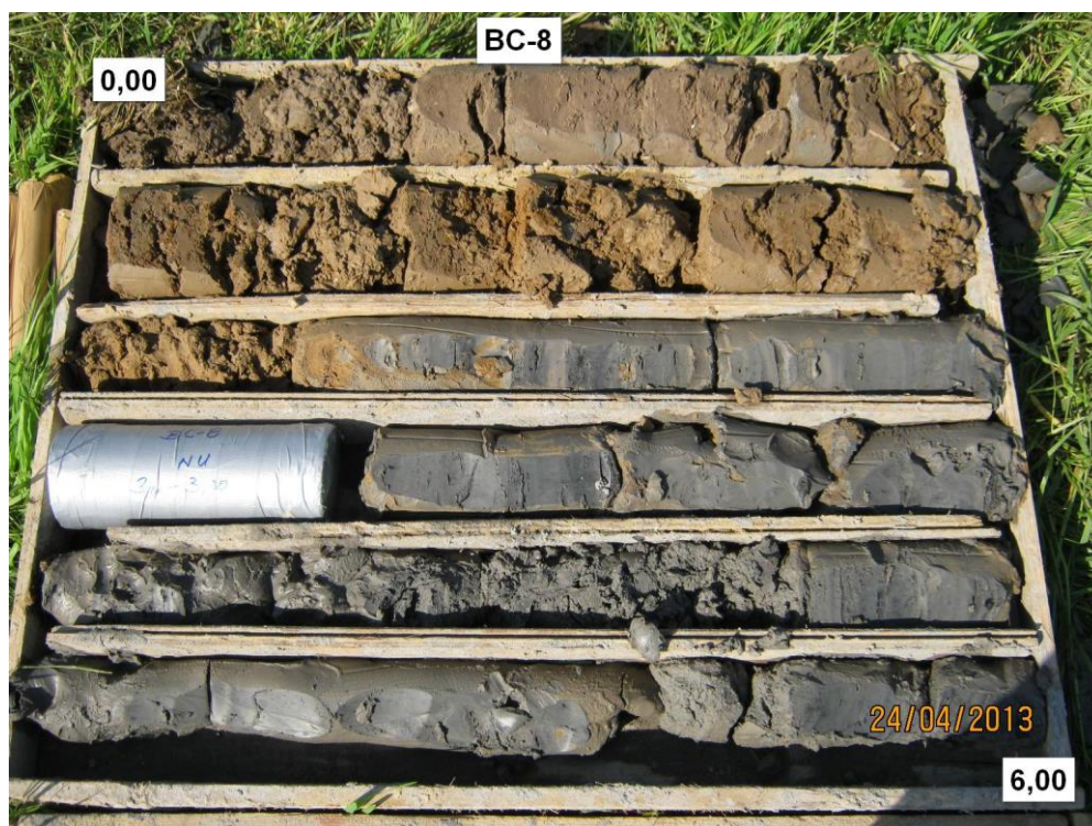
Slika 1. Jezgra istražne bušotine BC-8 (0,0-6,0 m)
