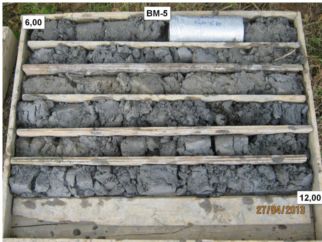
Slika 2. Jezgra istražne bušotine BM-5 (6,0-12,0 m)
