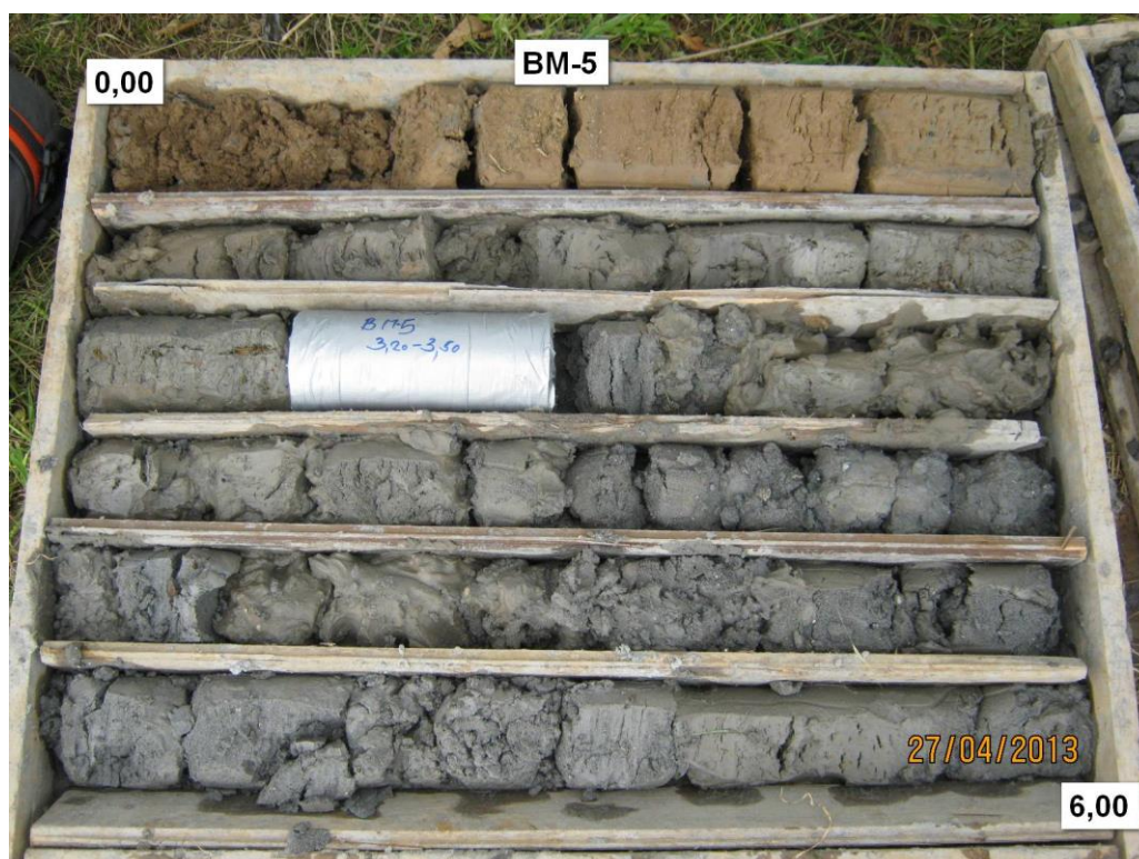
Slika 1. Jezgra istražne bušotine BM-5 (0,0-6,0 m)
