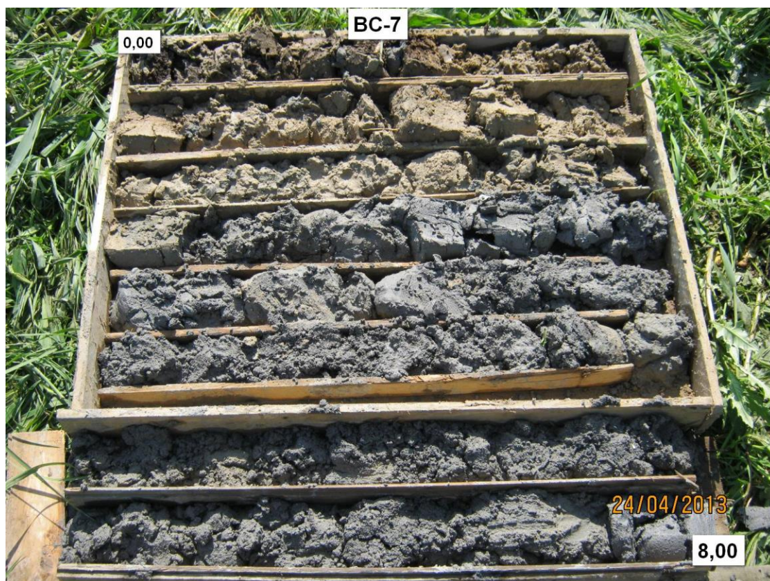
Slika 1. Jezgra istražne bušotine BC-7 (0,0-8,0 m)
