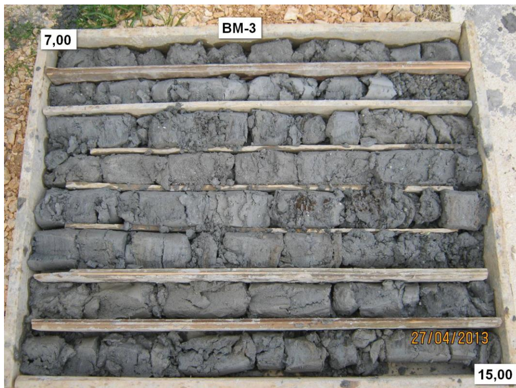
Slika 2. Jezgra istražne bušotine BM-3 (7,0-15,0 m)
