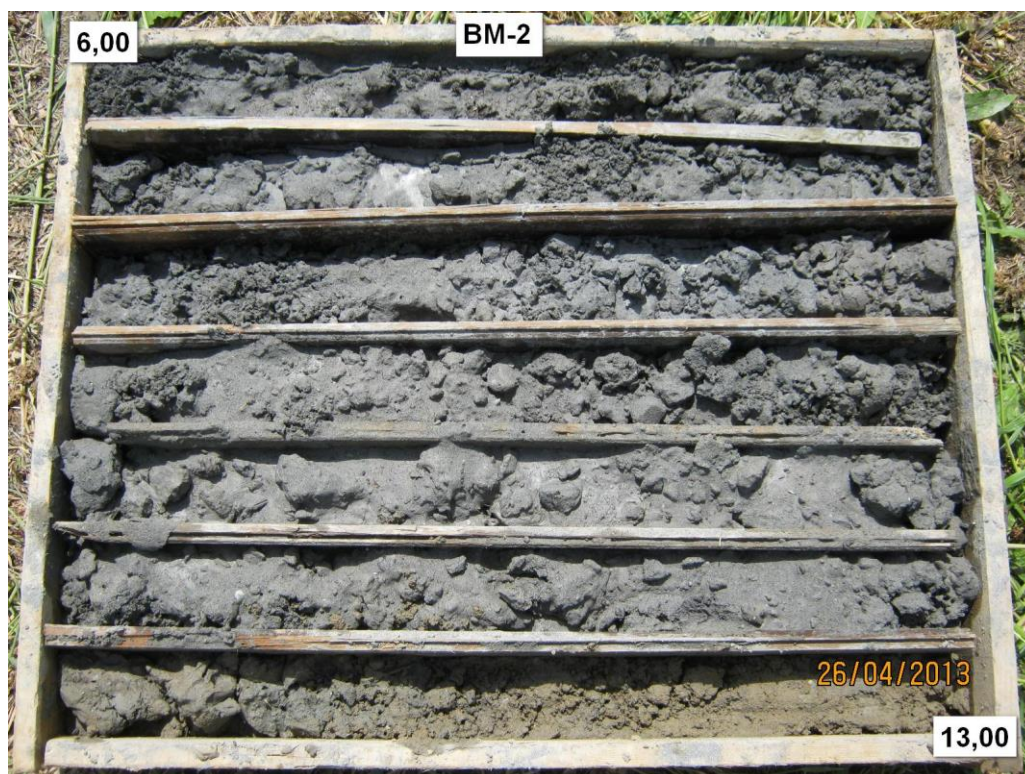
Slika 2. Jezgra istražne bušotine BM-2 (6,0-13,0 m)
