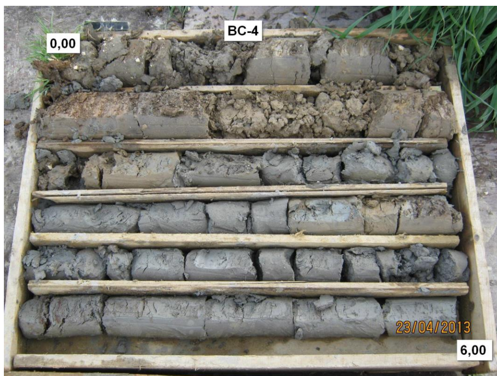
Slika 1. Jezgra istražne bušotine BC-4 (0,0-6,0 m)
