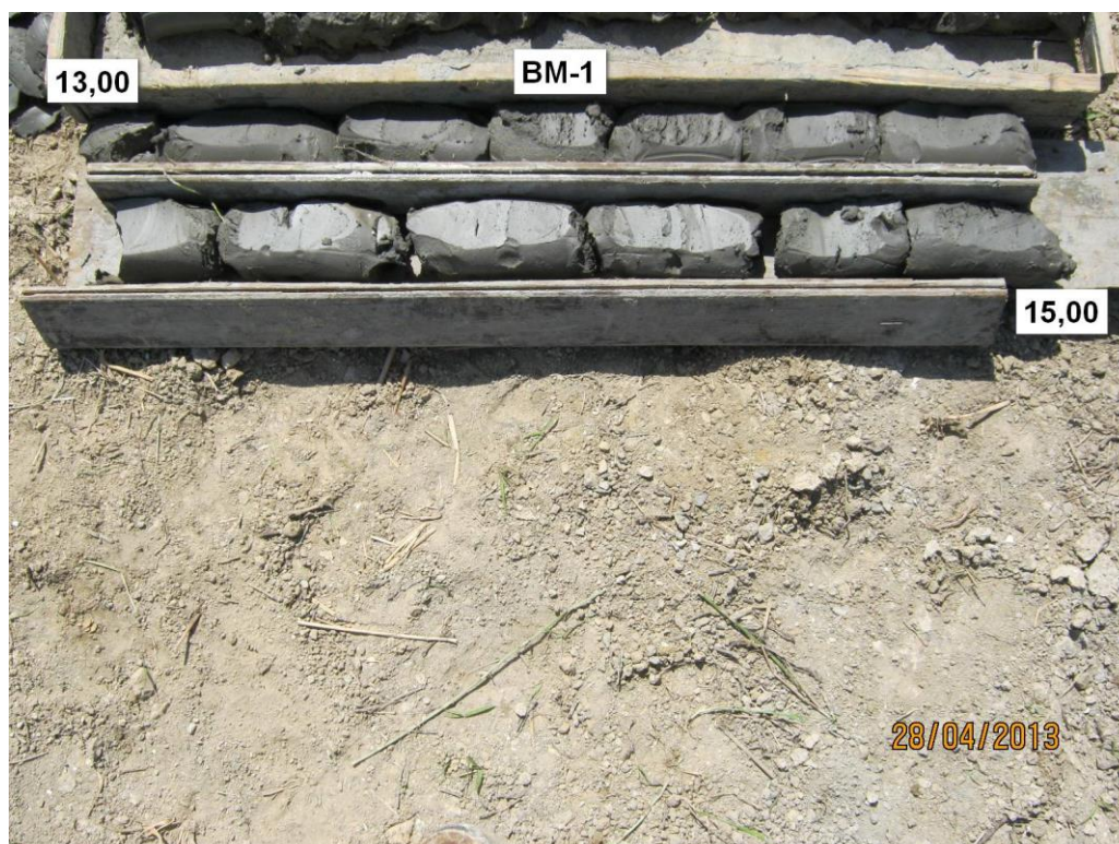
Slika 3. Jezgra istražne bušotine BM-1 (13,0-15,0 m)
