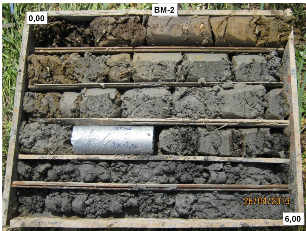
Slika 1. Jezgra istražne bušotine BM-2 (0,0-6,0 m)
