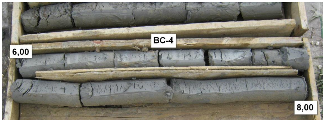
Slika 2. Jezgra istražne bušotine BC-4 (6,0-8,0 m)
