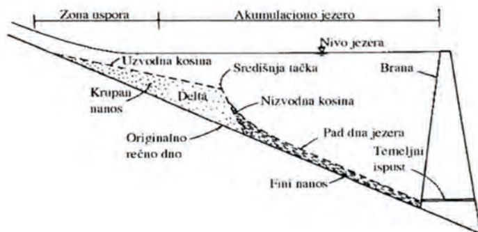
Slika 6. Najčešći raspored nanosnih naslaga u akumulaciji [5]
