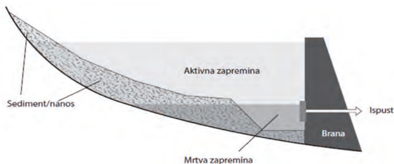
Slika 3. Gubitak volumena u zonama aktivne i mrtvog volumena usljed sedimentacije akumulacije
