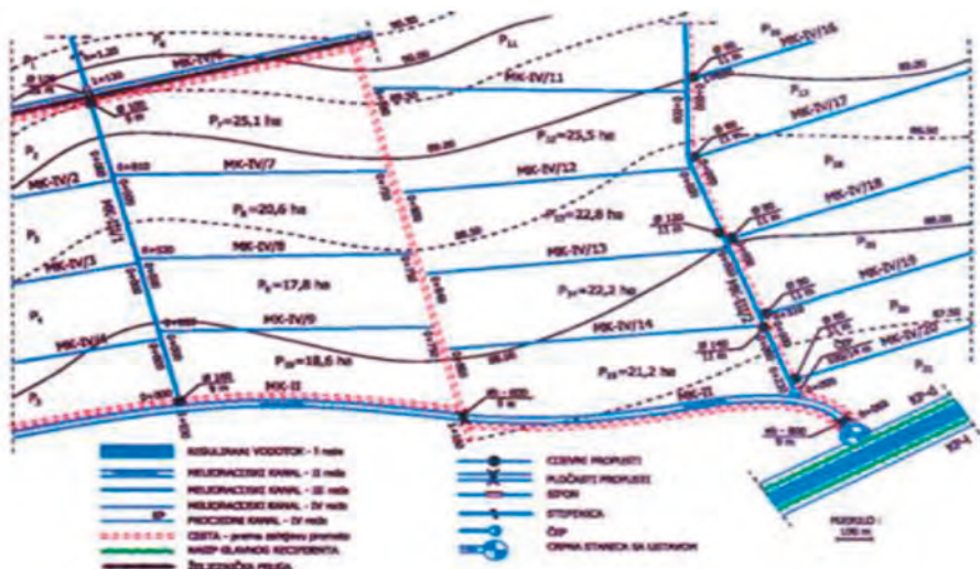
Slika 2. Hidromelioracijski sustavi površinske odvodnje s putnom mrežom i pripadajućim građevinama (Marušić i Holjević, 2019.)
