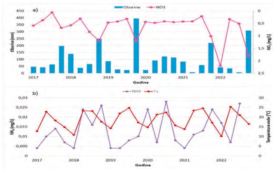
Slika 4. Izvor Vela Fontana u razdoblju od 2017. do 2022. godine a) nitrati u odnosu na količinu oborina b) amonij u odnosu na temperaturu vode
