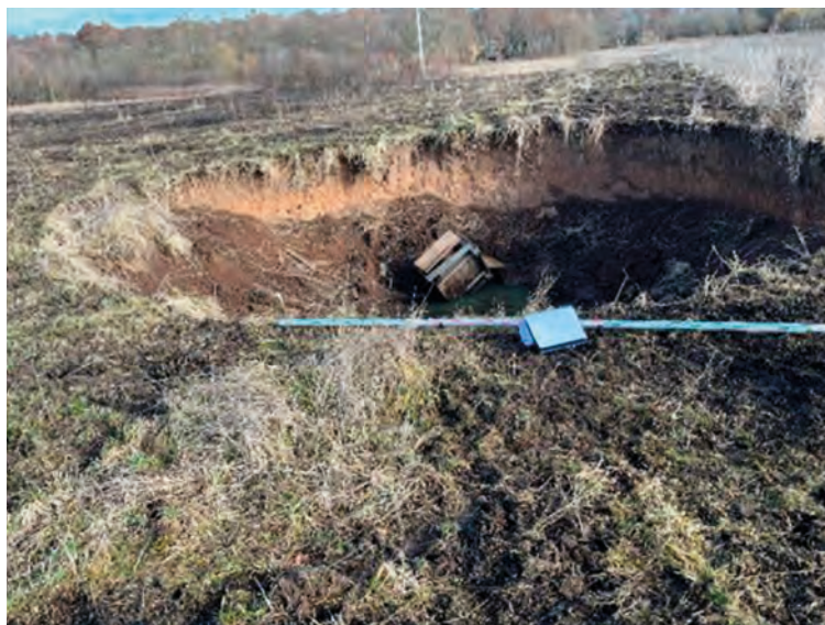
Slika 10. Vrtača UVM 063 k.o. Mečenčani - promjer 9 m, dubina 4 m, volumen 254,4 m 3
