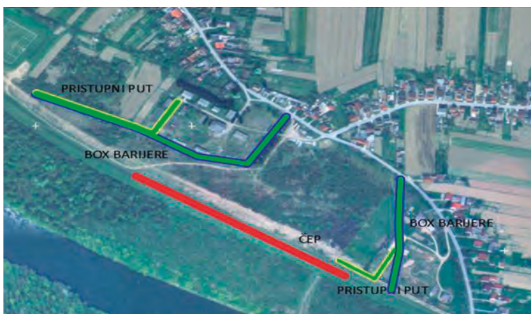
Slika 12. Galdovo - oštećenja nasipa (crveno), linija obrane od poplava (zeleno)
