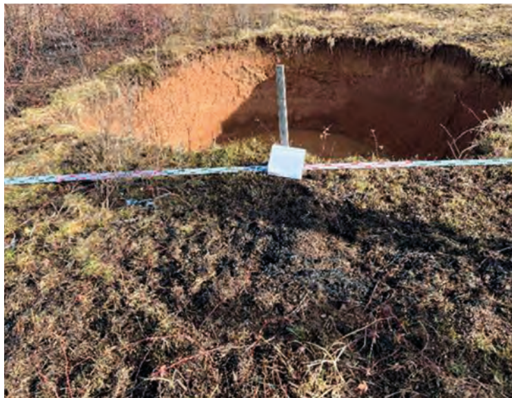
Slika 8. Vrtača UVM 048, k.o. Mečenčani - promjer 4,5 m, dubina 3 m, volumen 47,9 m 3
