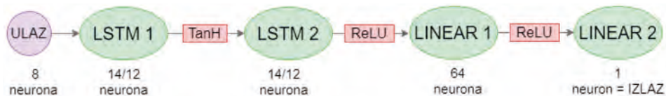
Slika 5. Arhitektura modela: prikaz slojeva i aktivacijskih funkcija
