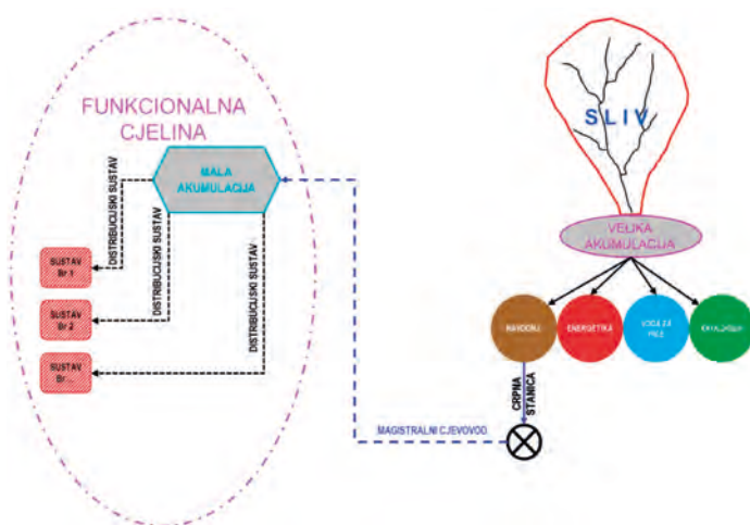
Slika 6. Konceptijsko rješenje zahvata i dovoda vode za navodnjavanje
