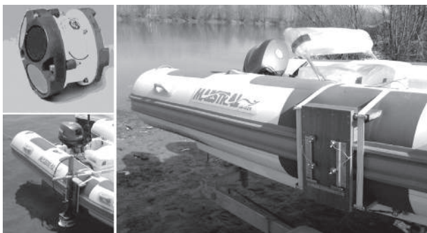
Slika 3. Prikaz ADCP strujomjera Rio Grande 1200kHz i načina pričvršćivanja na bok čamca
