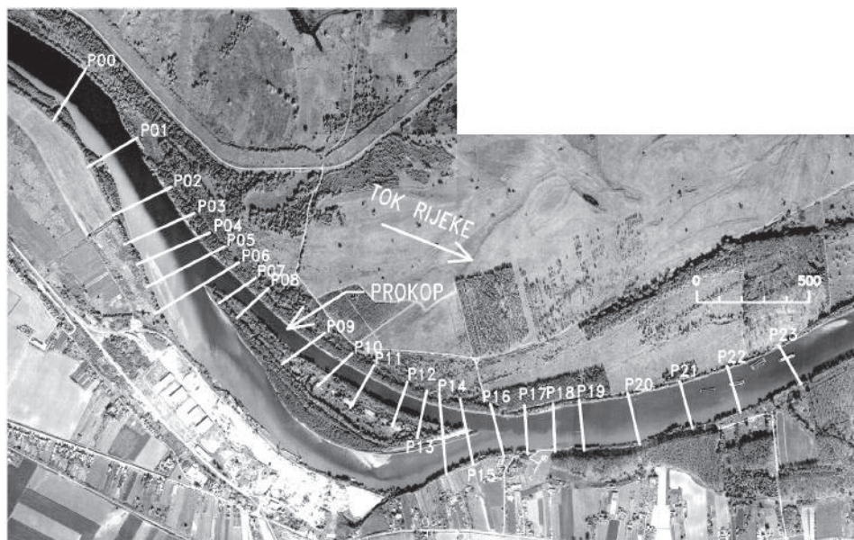
Slika 1.: Situacija prokopa Nemetin s mjestima kontrolnih poprečnih profila.
