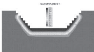
Slika 6.: Rasporod saturiranosti u početnim trenucima rada odteretnog kanala
