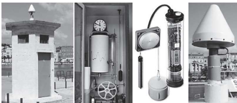
Slika 1.: Mareograf Split - luka opremljen analognim i digitalnim mareografom te CGPS stanicom.
