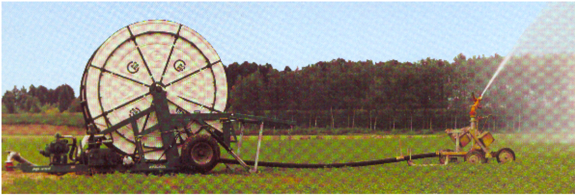
Slika 15. Samohodna sektorska prskalica -Typhon u radu
