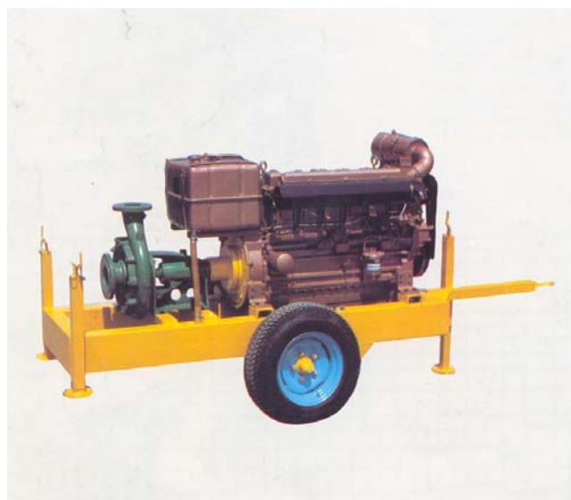
Slika 20. Motorna crpka tvrtke Caprari, MEC – A 4/100A s diesel motorom (usisavanje do 7m)
