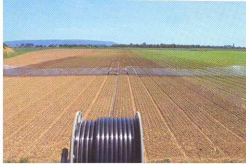
Slika 18. Samohodna sektoraska prskalica sa kišnim krilom u radu
