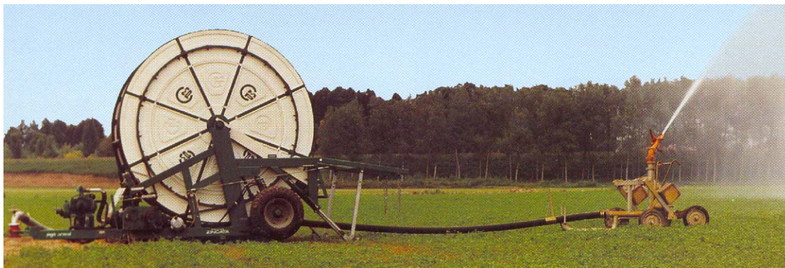
Slika 17. Samohodna sektorska prskalica -Typhon u radu
