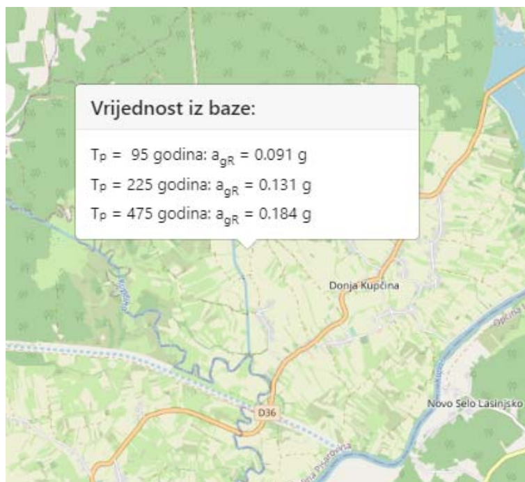
Slika 3-11: Iznosi poredbenog vršnog ubrzanje tla tipa A ( a_{gR} ).
