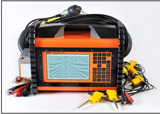
Slika 2. Prikaz digitalnog seizmografa TERRALOC ABEM PRO 2 i njegovih specifikacija.
